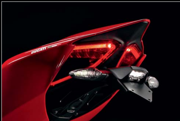
Portatarga in carbonio e lega d'alluminio Carbon and aluminium alloy plate holder
