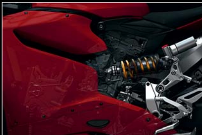
Motore portante Stressed-element engine
