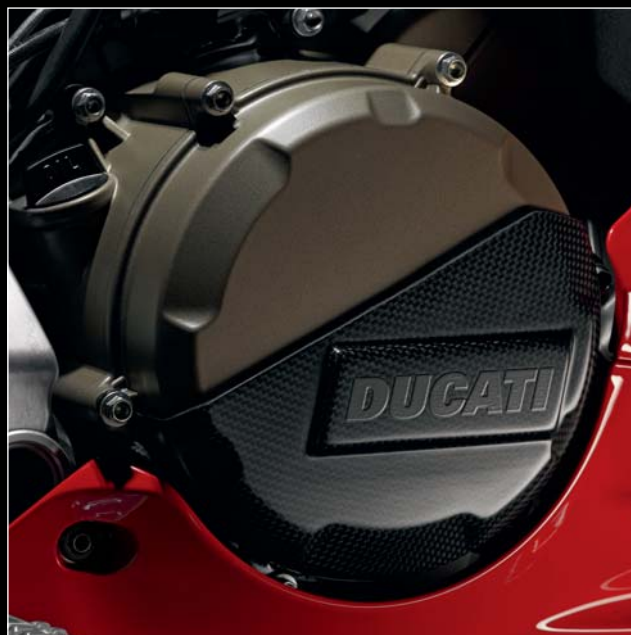
Protezione in carbonio per carter frizione 96451011B Carbon cover for clutch case
